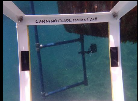
Herramientas desarrolladas por investigadores del ARDITI (MARINELAB) para el muestreo de especies introducidas o invasoras (NIS) en distintos ambientes e infraestructuras costeras. (Figura 13)
