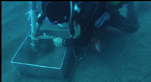
Inspección visual a bordo después de finalizar la operación de extracción de arena (@ImagDOP; incluido en el método de monitorización de la integridad del suelo marino). (Figura 16)
