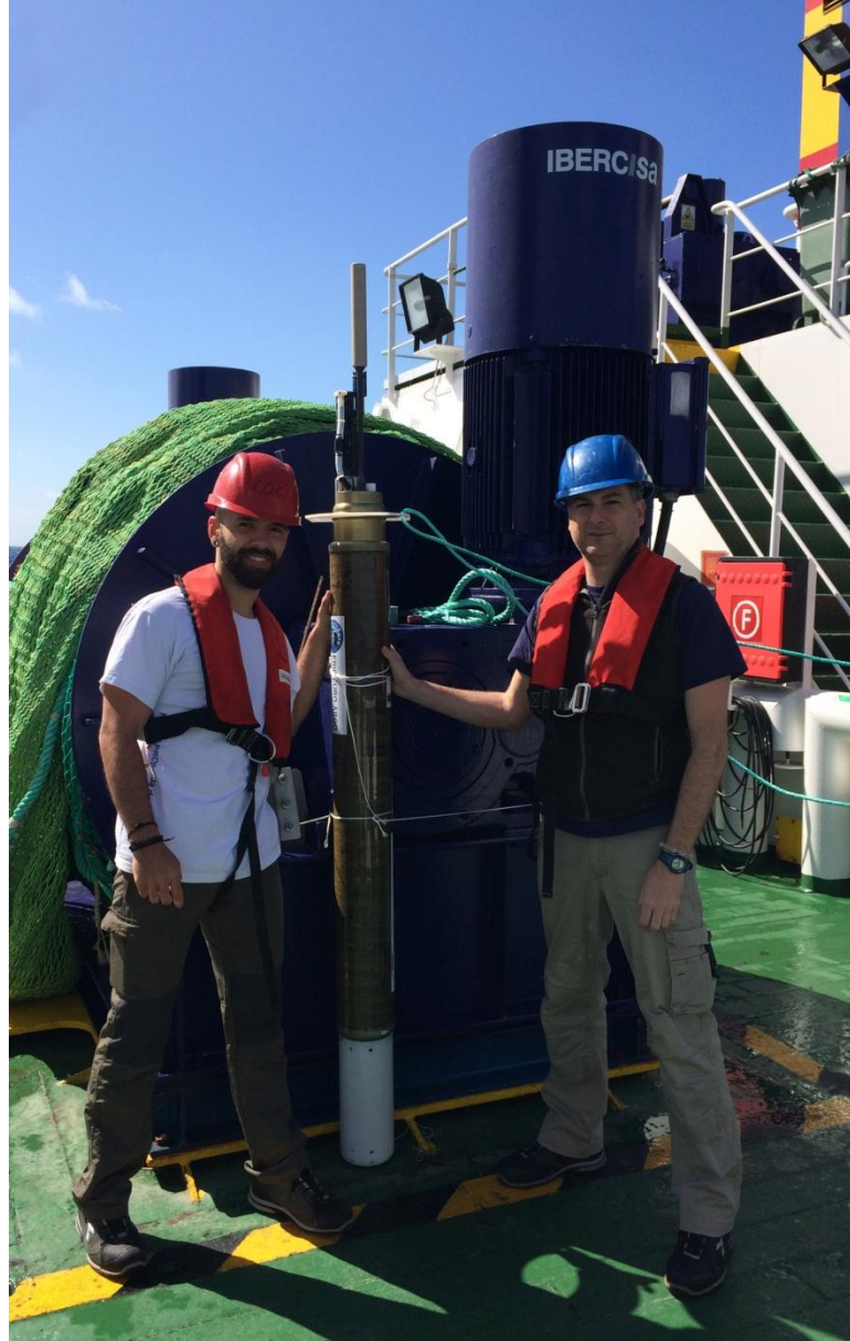
Componentes del equipo Argo España (Alberto González Santana, a la izquierda, y Pedro Vélez Belchí, a la derecha) junto a un perfilador tipo Deep-Argo, capaz de alcanzar los 4000 metros de profundidad [Fuente: Argo España]. (Figura 2).
