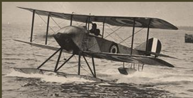
Figura 7. Un Sopwith Tabloid (variante Schneider) con flotadores que lo convierten en un hidroplano (Imagen y más información: https://en.wikipedia.org/wiki/Sopwith_Tabletoid ).
