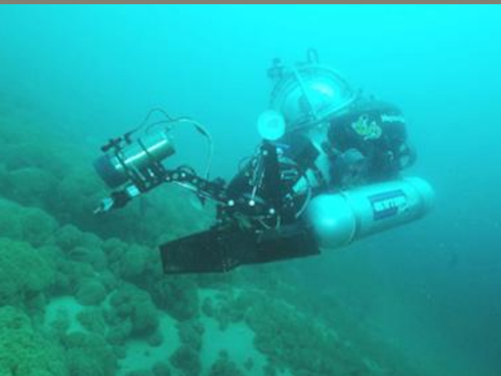
Figura 2. Sumergible "DeepWorker 2000" creado por Sylvia Earle (Imagen extraída de la ficha técnica del sumergible).
