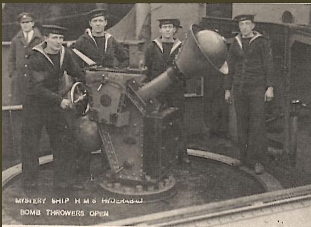
Figura 4. "Bomb Thrower" (BT 7,5 Inch) con una carga de profundidad Tipo F a bordo del HMS Hyderabad, un barco camuflado clase "Q-ship", también llamados "Mystery". Imagen de la George Malcolmson Collection. http://www.navweaps.com/Weapons/WAMBR_ASW.php
