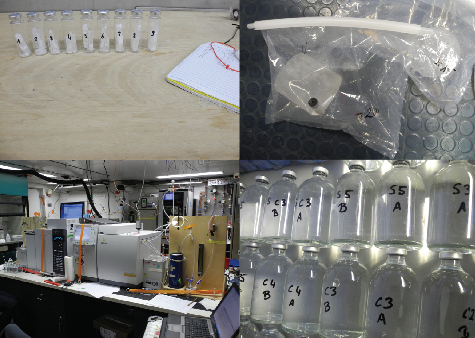
Fig. 4. Equipo de laboratorio a bordo: (A) muestras de hielo en viales impermeables al gas de 20 mL para el análisis de DMS y DMSP; (B) muestras de hielo en bolsas impermeables al gas para el análisis de metano; (C) cromatógrafo de gases en el laboratorio del barco para el análisis de metano, DMS y DMSP a bordo; (D) botes impermeables a gases para los experimentos de incubación.
