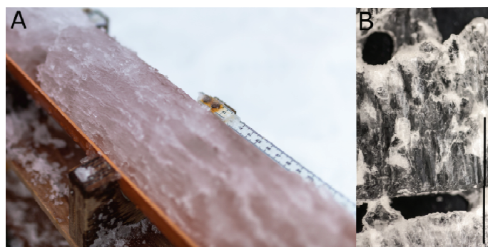
Fig. 2. Fotografías de los testigos de hielo marino: (A) muestra una sección de un testigo de hielo, de 9 cm de diámetro, donde los canales verticales de salmuera son visibles en el hielo superficial; (B) un corte vertical, de aproximadamente 2 mm de grosor, de una sección fina de un testigo de hielo donde se observan los canales y los poros dentro de la matriz sólida del hielo. La barra negra indica la dirección vertical en el interior del testigo de hielo y tiene un longitud de 5 cm (fotos cortesía de Stefan Hendricks).
