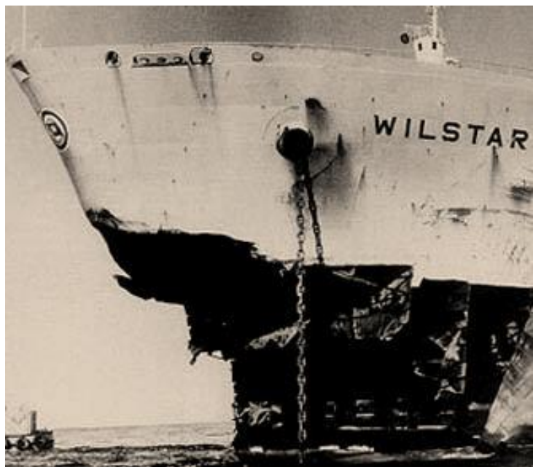
Figura 3: El tanque noruego Wilstar tras colisionar con una rogue wave en 1974. Tomado de bayourenaissanceman.blogspot.com (29.07.2017).
