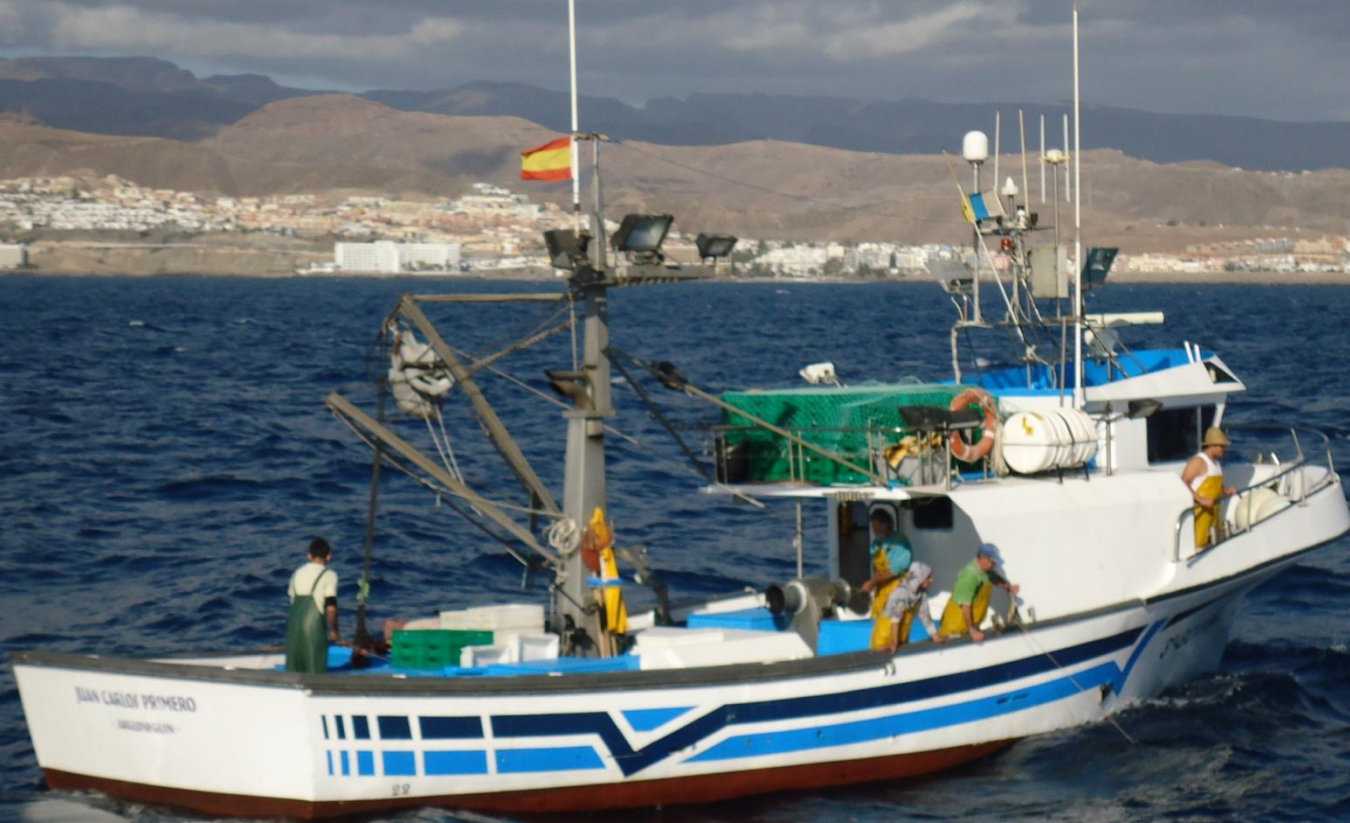
Figura 2. Barco polivalente de pesca artesanal dedicado a la captura de especies pelágico costeras, mediante cerco o traíña, y de túnidos, con cebo vivo durante la zafra.
